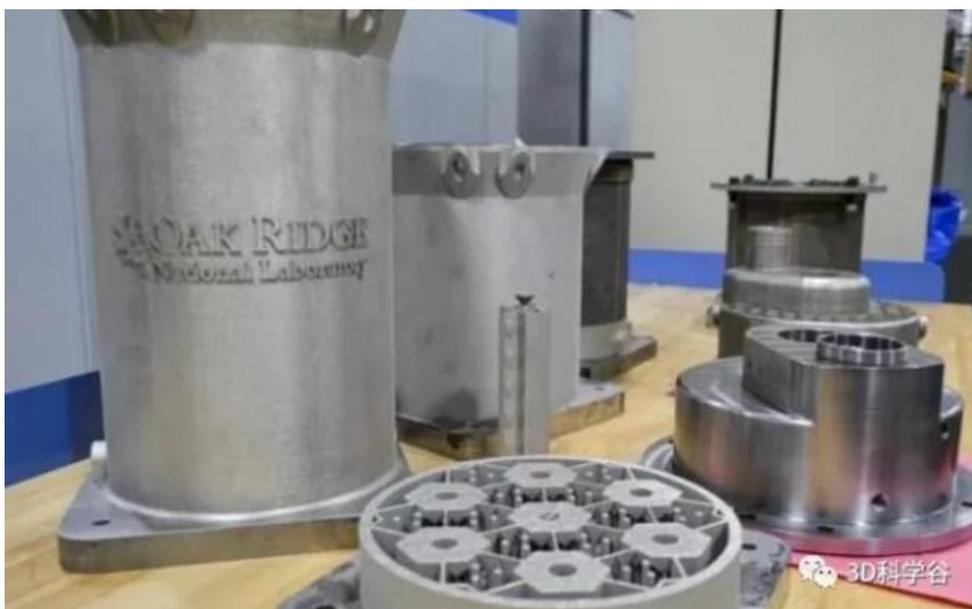
橡树岭国家实验室结合先进的材料和 21 世纪的反应堆设计，通过 3D 打印技术在大幅降低成本的同时加快反应堆开发进程，用更少的零部件制造先进的、全尺寸的 3D 打印反应堆堆芯，并集成传感器和控制装置到反应堆。
